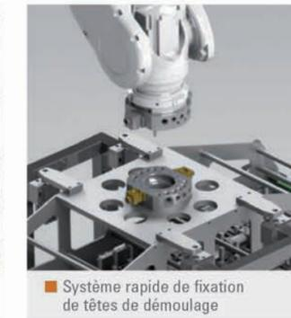
■ Système rapide de fixation de têtes de démoulage
