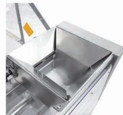
■ Trémie de réception du pâton sortie balancelle
