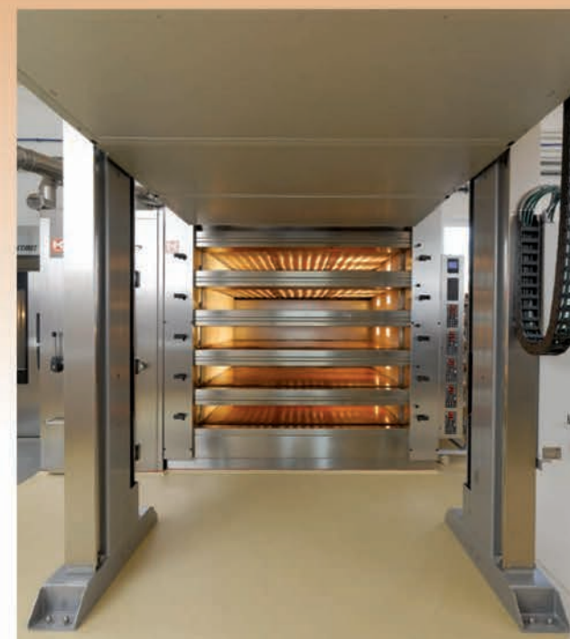
■ Enfourneur en position haute
