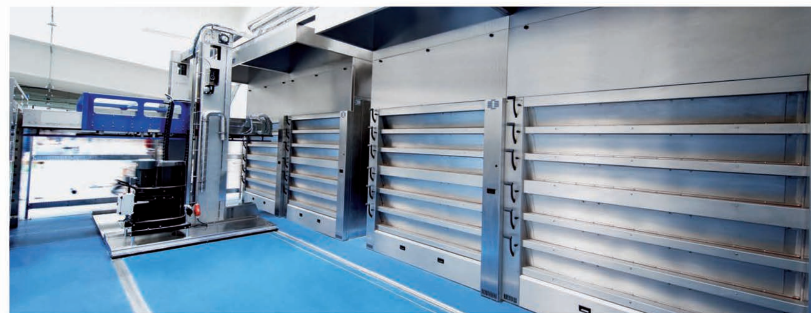
■ Installation de 4 COLUMBUS EO 620 avec enfourneur automatique
