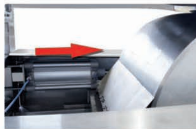
■ Réglage pneumatique de la courroie métallique
