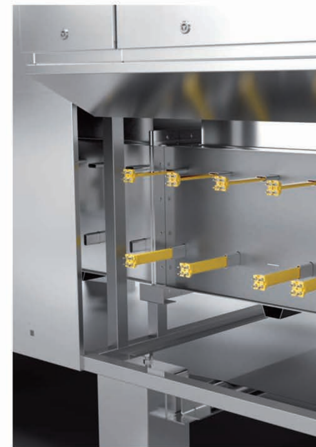
■ Chauffé par résistances électriques (12 par mètres linéaires). Elles sont placées sur la voûte et sur la sole. Facilement accessibles
